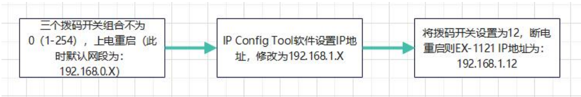
图 1-5-7 使用拨码进行 IP 网段设定
